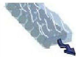
Enrochements jointifs disposés les uns contre les autres de manière compacte et formant un tapis rugueux.
